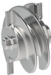
Rotor de doble hélice realizado en fusión a la cera perdida para la creación del anillo líquido en el interior de la parte anterior del cuerpo.
